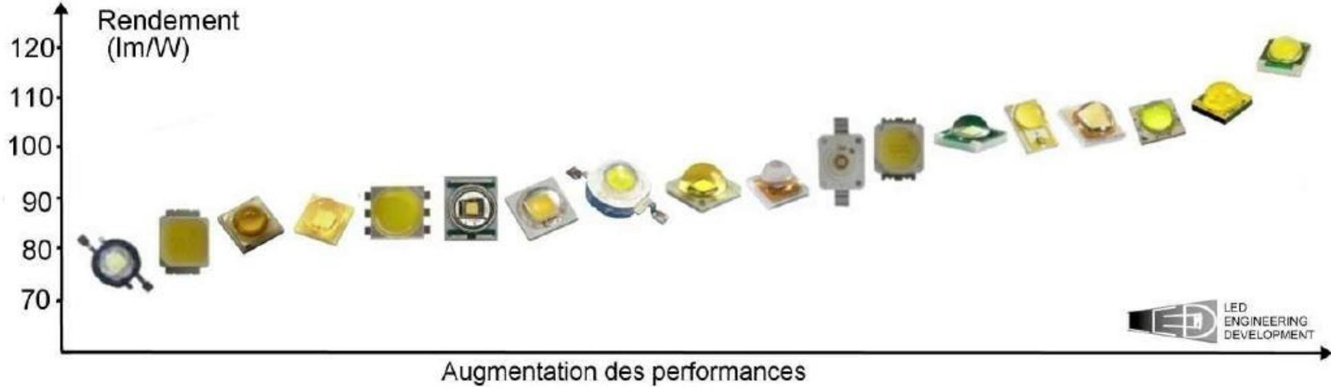
Rendement (lm/W) de quelques modèles de LED de puissance présents dans le commerce (neutre 4000K, à 350mA, modèles fabriqués en 2011-2012)
