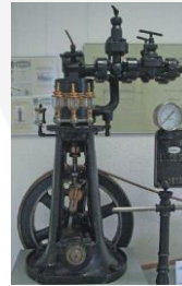
Compresseur LINDE NH3 1910
