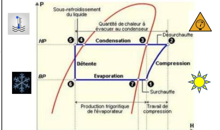
Le FF se charge en chaleur entre 6 et 1. Entre 6 et 7, le liquide s'évapore. Entre 7 et 1, le gaz monte en température. Le gaz sera comprimé sans difficulté entre 1 et 2. Le FF gazeux doit alors évacuer sa chaleur de 2 à 5 et redevient liquide. Celui-ci sera ensuite détendu pour revenir aux conditions d'évaporation entre 5 et 6.
